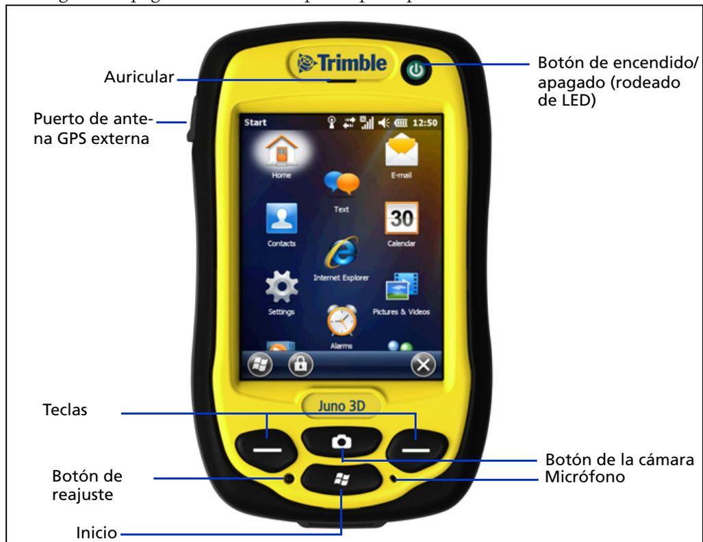
Figura 1.1 Colector de mano Juno series – Vista frontal del Juno 3B y Juno 3D
