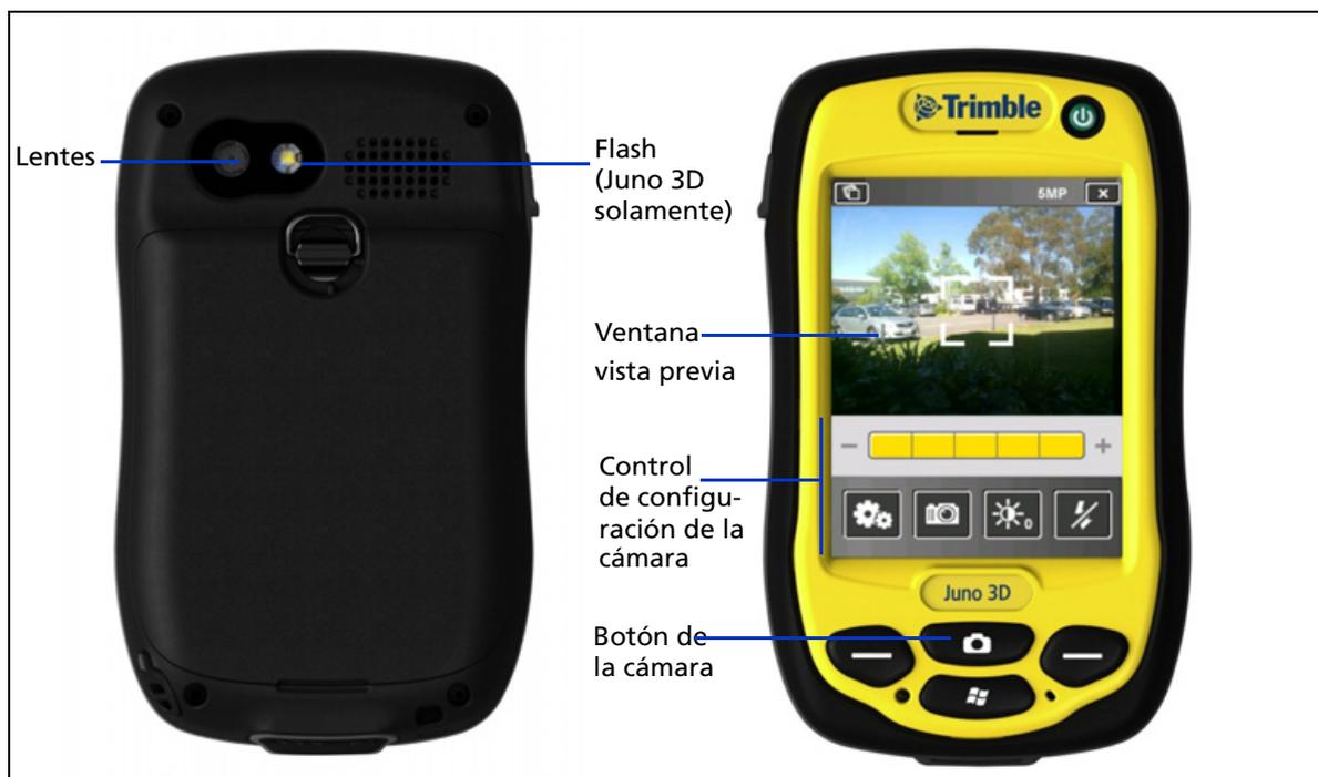
Figura 1.5 Colector de mano Juno series – controles de la cámara
