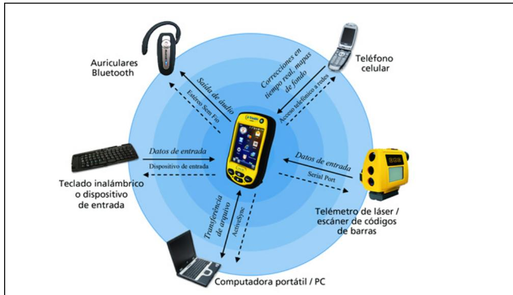
Figura 1.4 Conexiones de cliente Bluetooth del colector de mano Juno series
